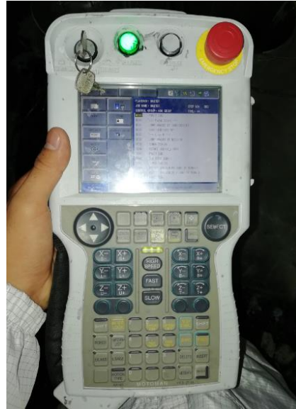
Fig. 38-a) Demuestra el robot MOTOMAN YASKAWA del cual se elaborará el tutorial para la programación y 38-b) Demuestra el controlados NX100 del robot desde el cual se manipulará dicho robot.
